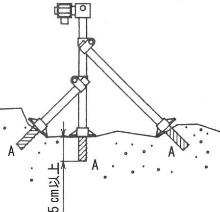
(図 24-1) A、(図 24-2) A の堀削穴は 5cm 以上の深さとする。
