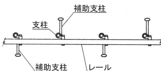
(3) レール上面から地上高 1m以上では、全支柱両サイドに補助支柱を設置する。
